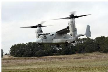
Tout d'abord, parlons un peu d'aéronautique, les ADAV, dont l'exemple le plus proche est le V-22 Osprey américain, sont des aéronefs qui décollent à la verticale en utilisant leurs moteurs puis réalisent une transition horizontale afin d'utiliser la portance de leur voilure fixe ; ce système permet
